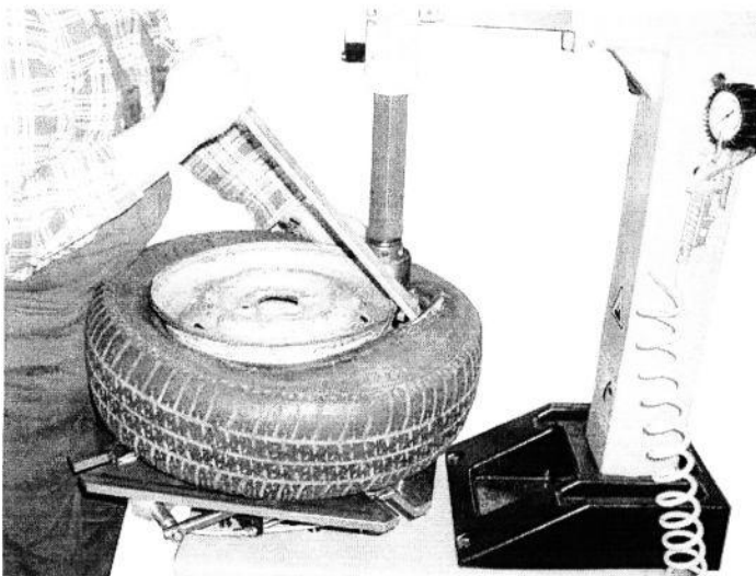
Fig. 10 pulling tyre edge onto shoe
